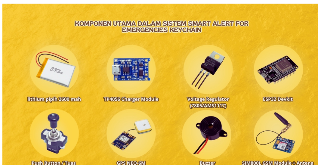
Gambar 3.4.1. Komponen Utama Smart Alert for Emergencies Keychain
