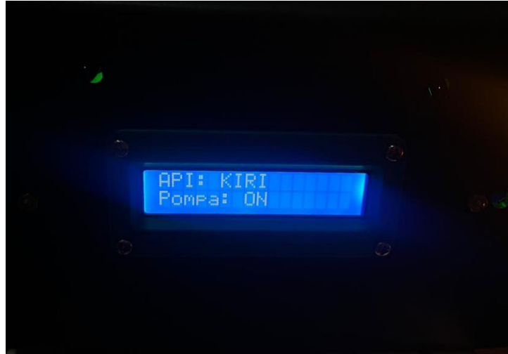
Gambar 4. 8 Tampilan LCD saat sensor 1 mendeteksi api
