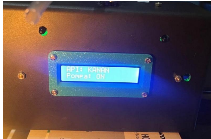
Gambar 4. 12 Tampilan LCD saat sensor 3 mendeteksi api
