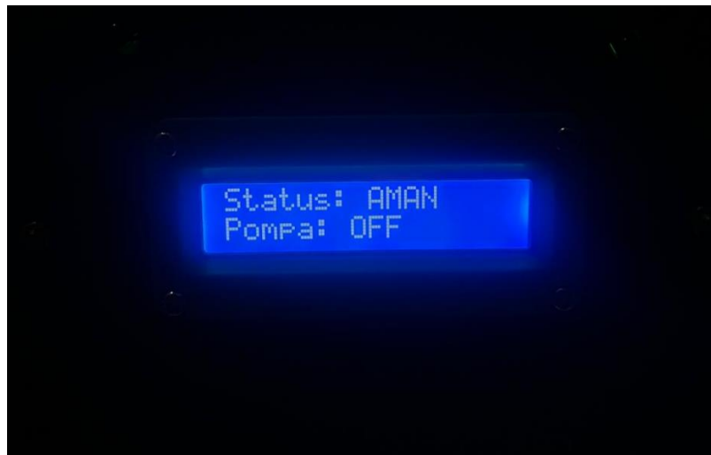
Gambar 4. 5 Tampilan LCD saat kondisi aman
