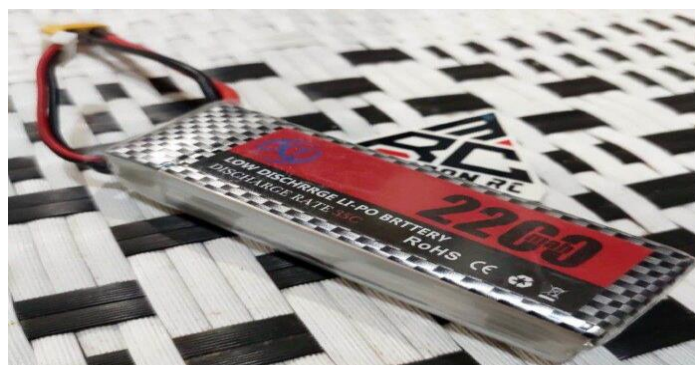
Gambar 2. 8 sumber kelistrikan kapal prototipe PSV
