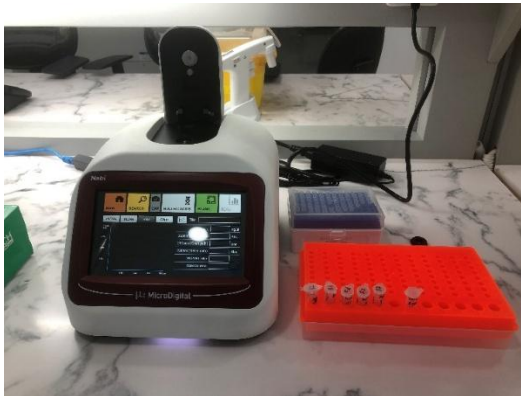
Pemeriksaan konsentrasi dan absorbansi RNA dengan Spektrofotometer NABI UV-Vis
