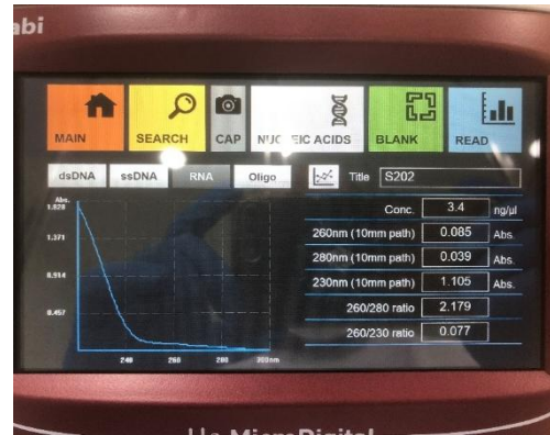
Hasil pengukuran Aborbansi dengan Spektrofotometer NABI UV-Vis
