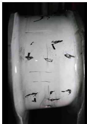
Gambar 4.14 Hasil uji magnetic particle inspection (MPI) pada crankpin cylinder nomor 2 (PT. Waruna Shipyad Indonesia)
