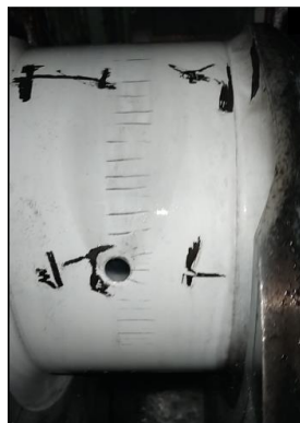
Gambar 4.13 Hasil uji magnetic particle inspection (MPI) pada crankpin cylinder nomor 1 (PT. Waruna Shipyad Indonesia)
