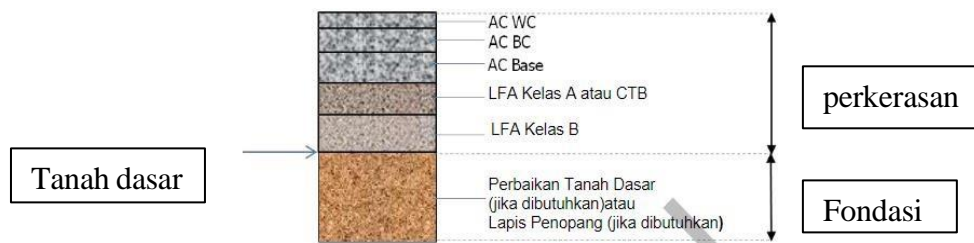
Gambar 2.1 Bagian Lapisan Konstruksi perkerasan Lentur (Bina Marga,2017)
