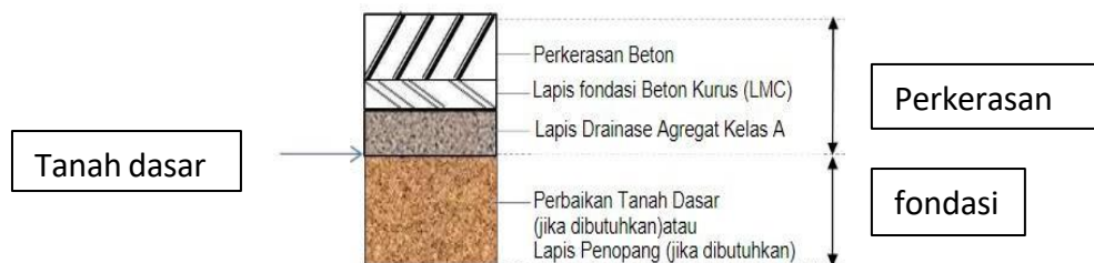
Gambar 2.2 Bagian Lapisan Konstruksi Perkerasan Kaku (Bina Marga,2017)
