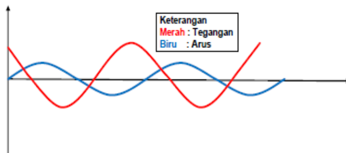
Gambar 2.6 Gelombang arus dan tegangan pada beban induktif
