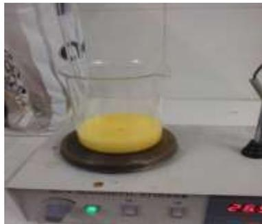
Gambar 26. Pemanasan dengan Hot Plate
