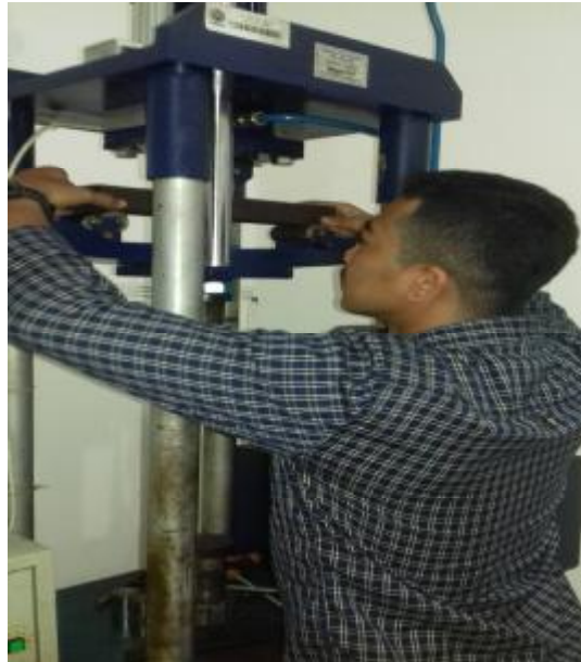
Gambar 4.2 Mengatur Dudukan Spesimen Di Mesin UTM
