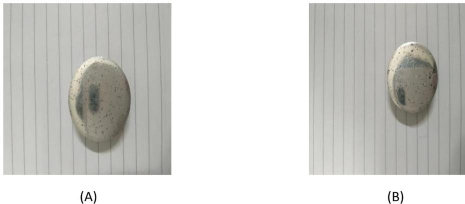
Gambar 4.10 Spesimen pengujian struktur mikro dan cacat porositas. (A) Spesimen pengikat air kaca, (B) Spesimen pengikat bentonit.
