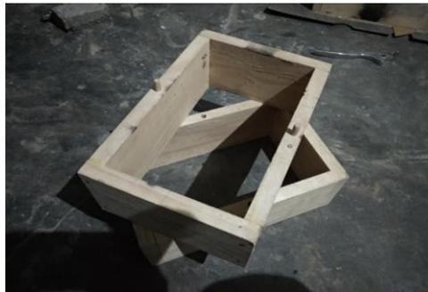
Gambar 3.6 Kotak cetak.
