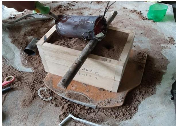
Gambar 3.18 Proses penuangan aluminium cair.
