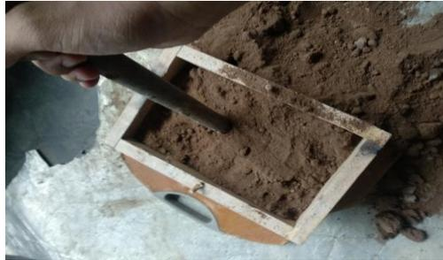
Gambar 3.15 Proses pencetakan pola
