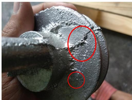
Gambar 4.9 Cacat yang disebabkan pasir cetak yang melekat pada permukaan produk hasil coran.
