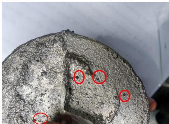
Gambar 4.7 Cacat lubang jarum pada produk
