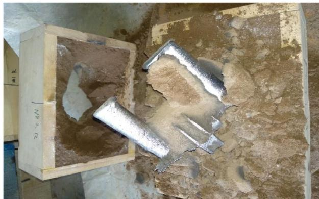
Gambar 3.19 Pembongkaran cetakan
