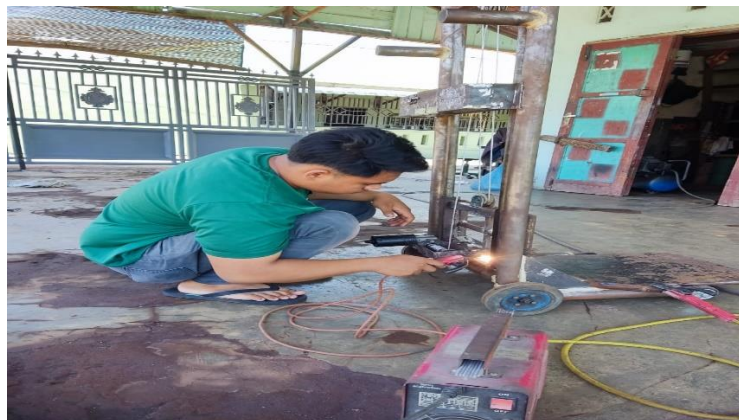
Gambar 4.11 proses pembuatan dudukan motor listrik
