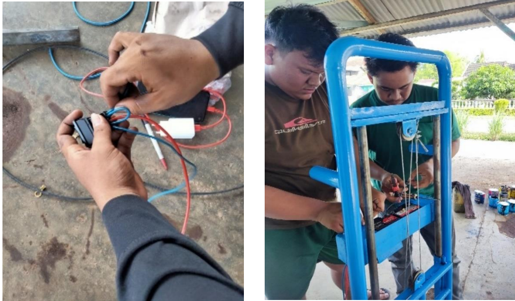
Gambar 4.13 proses perakitan kelistrikan pada troli
