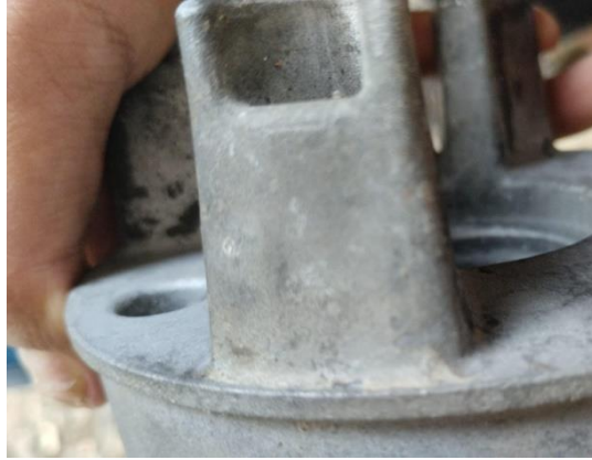
Gambar 4.14 Hasil blasting room dengan tekanan angin 4 bar dan jarak tembakan 100 mm.
