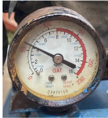
Gambar 4.8 Tekanan angin 4 bar dan jarak penyemprotan 100 mm.
