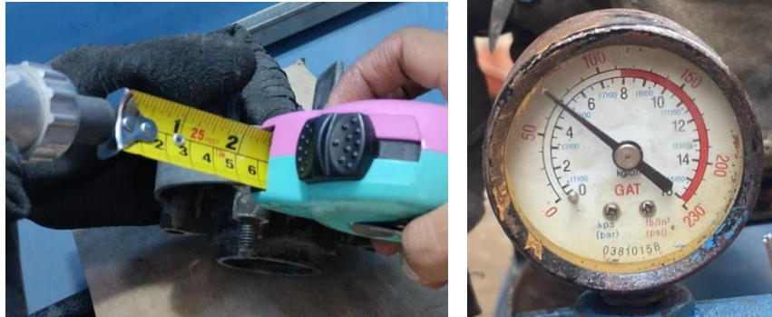
Gambar 4.6 Tekanan angin 5 bar dan jarak penyemprotan 60 mm.
