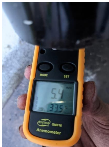
Gambar 4.31 Pengukuran Udara di Lubang Out .
