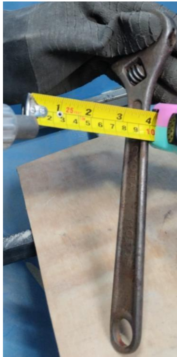
Gambar 4.8 Tekanan angin 4 bar dan jarak penyemprotan 100 mm.
