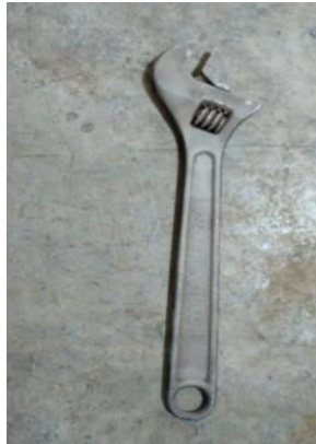
Gambar 4.27 Sesudah di Sandblasting
