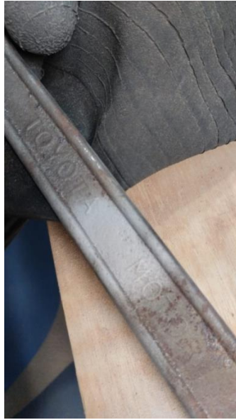
Gambar 4.19 Hasil blasting room dengan tekanan angin 6 bar dan jarak penyemprotan 30 mm.
