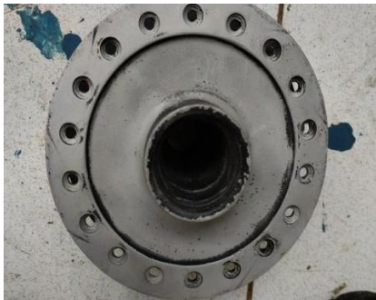
Gambar 4.29 Sesudah di Sandblasting
