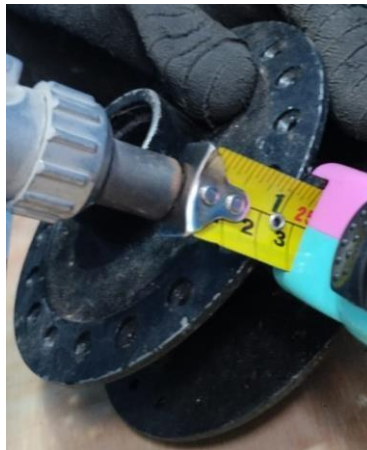
Gambar 4.13 Tekanan angin 6 bar dan jarak penyemprotan 30 mm.
