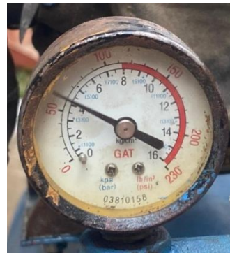
Gambar 4.11 Tekanan angin 4 bar dan jarak penyemprotan 100 mm.
