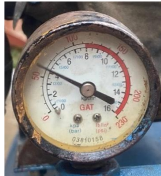
Gambar 4.5 Tekanan angin 4 bar dan jarak penyemprotan 100 mm.
