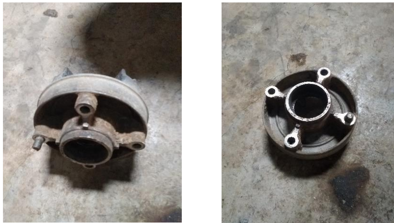
Gambar 4.24 Bahan Sebelum di Sandblasting
