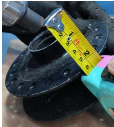
Gambar 4.12 Tekanan angin 5 bar dan jarak penyemprotan 60 mm.
