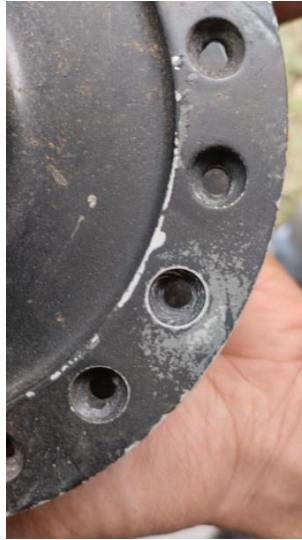
Gambar 4.20 Hasil blasting room dengan tekanan angin 4 bar dan jarak penyemprotan 100 mm.
