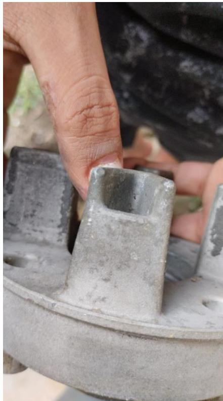
Gambar 4.15 Hasil blasting room dengan tekanan angin 5 bar dan jarak penyemprotan 60 mm.
