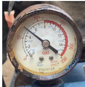
Gambar 4.9 Tekanan angin 5 bar dan jarak penyemprotan 60 mm.
