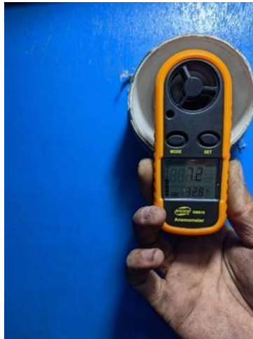
Gambar 4.30 Pengukuran Udara di Lubang In .
