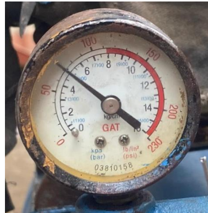
Gambar 4.12 Tekanan angin 5 bar dan jarak penyemprotan 60 mm.
