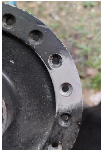
Gambar 4.21 Hasil Blasting Room dengan tekanan angin 5 bar dan jarak penyemprotan 60 mm.
