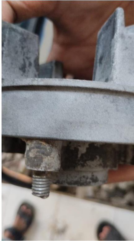
Gambar 4.16 Hasil blasting room dengan tekanan angin 6 bar dan jarak penyemprotan 30 mm.
