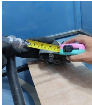
Gambar 4.5 Tekanan angin 4 bar dan jarak penyemprotan 100 mm.
