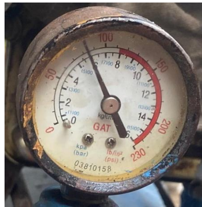
Gambar 4.10 Tekanan angin 6 bar dan jarak penyemprotan 30 mm.
