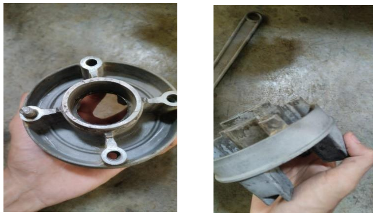
Gambar 4.25 Bahan Sesudah di Sandblasting
