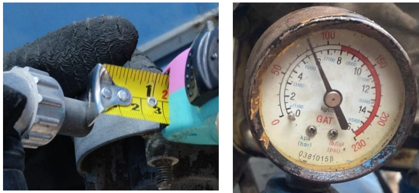
Gambar 4.7 Tekanan angin 6 bar dan jarak penyemprotan 30 mm.
