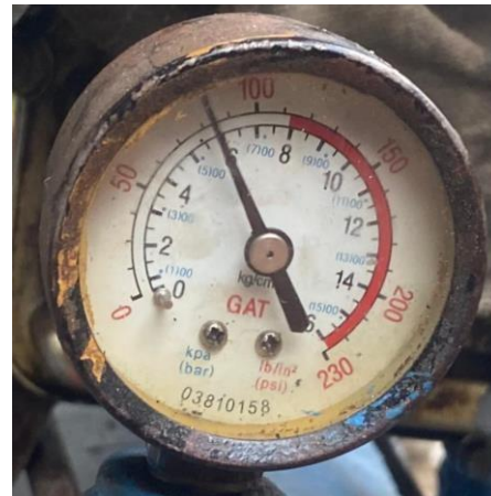
Gambar 4.13 Tekanan angin 6 bar dan jarak penyemprotan 30 mm.
