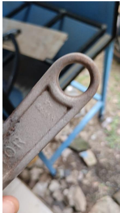
Gambar 4.18 Hasil blasting room dengan tekanan angin 5 bar dan jarak penyemprotan 60 mm.
