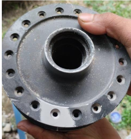
Gambar 4.22 Hasil Blasting Room dengan tekanan angin 6 bar dan jarak penyemprotan 30 mm.
