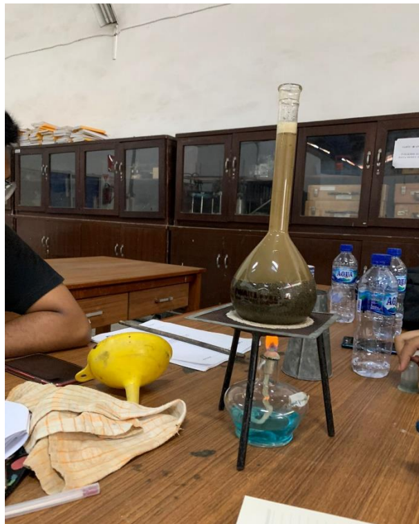
Gambar Lampiran- 28: Pengujian berat jenis dan penyerapan air.
