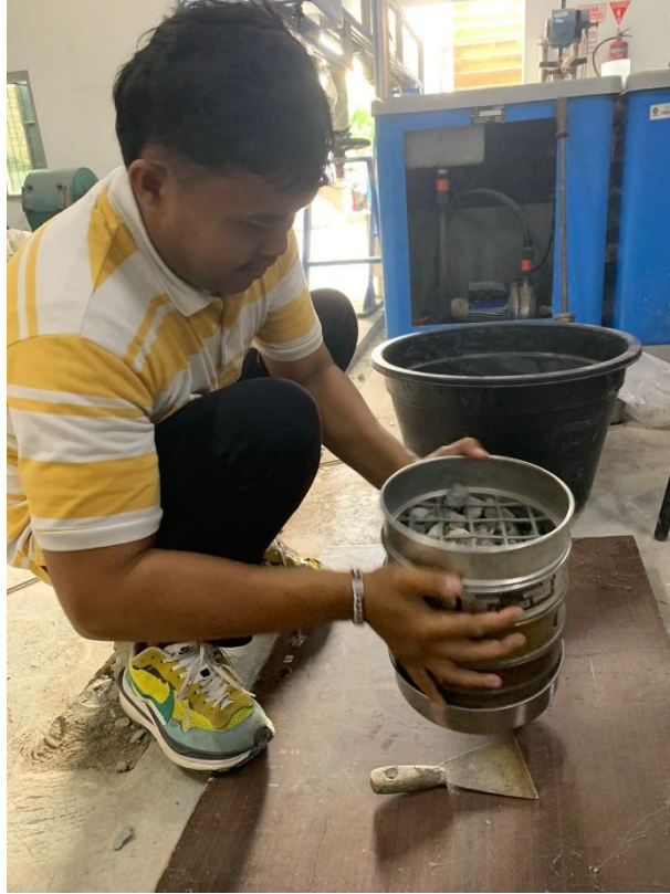
Gambar Lampiran- 27: Pengujian analisa saringan.
