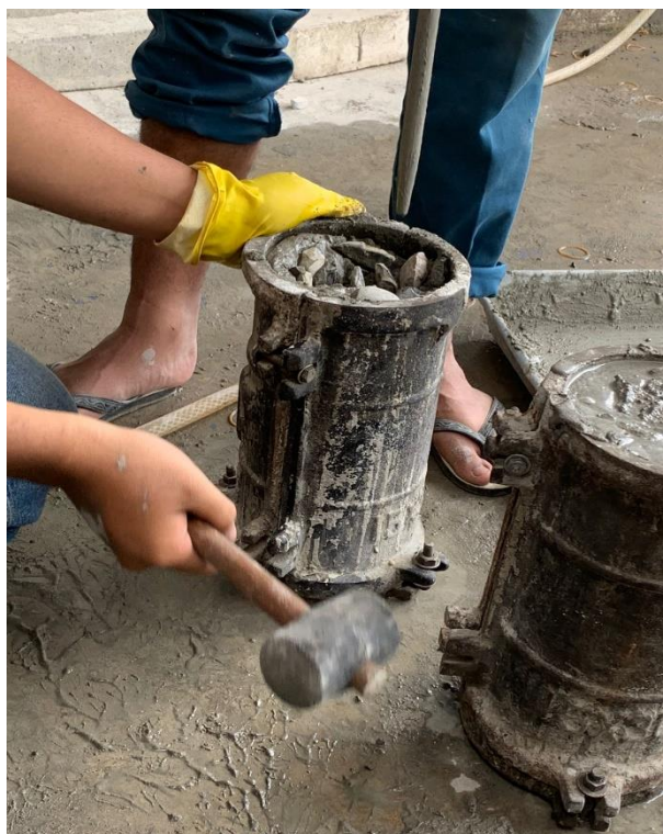
Gambar Lampiran- 32: Pembuatan benda uji.
