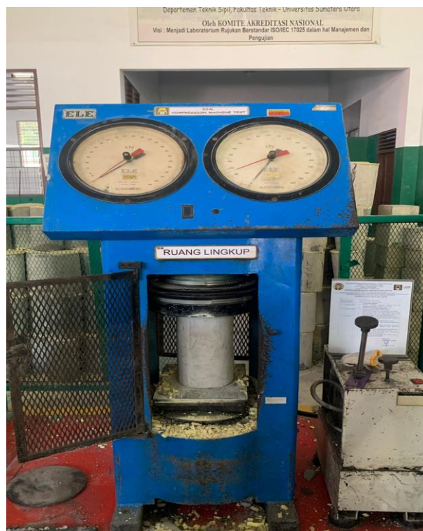
Gambar Lampiran- 34: Pengujian kuat tekan di lab beton USU
