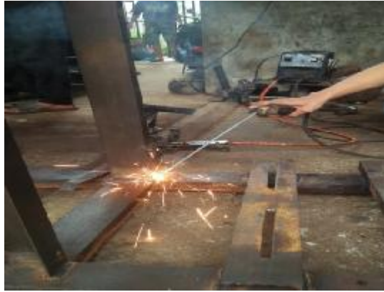
Gambar 4.12. Proses pengelasan rangka
