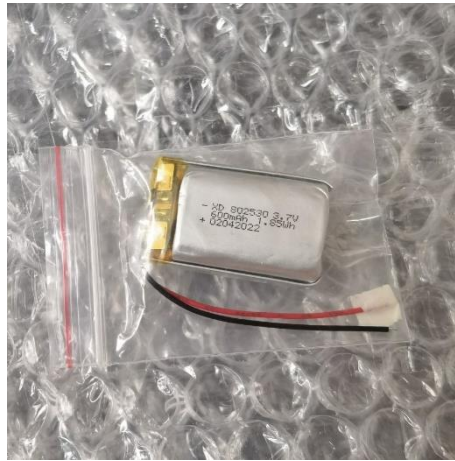
Gambar 2.6 Baterai Li-Po 3,7V
