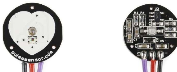
Gambar 2.2 Pulse Sensor tampak depan dan belakang
