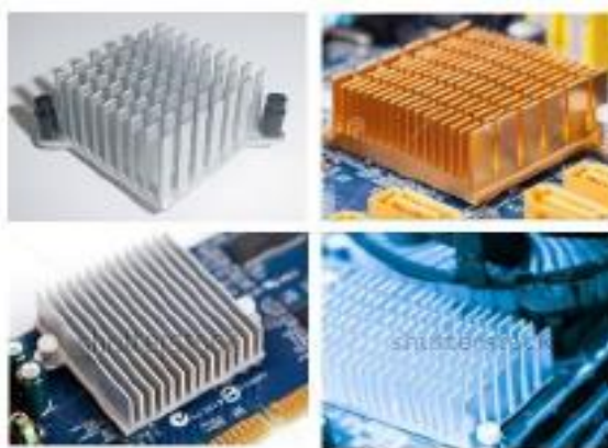
Gambar.2.3. Bentuk-bentuk dari Heatsink
