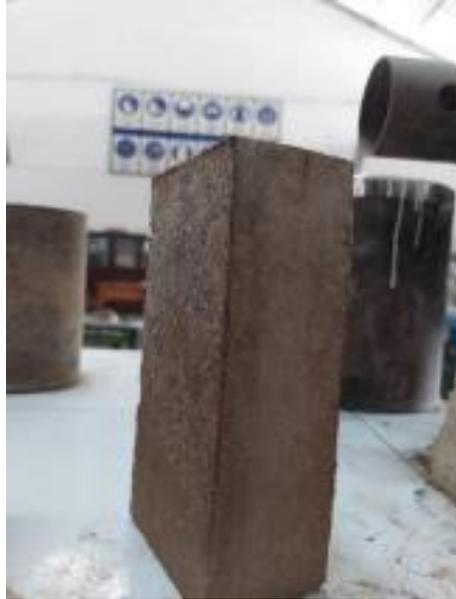
**Gambar 4.8** Kondisi bata setelah di uji kadar garam
