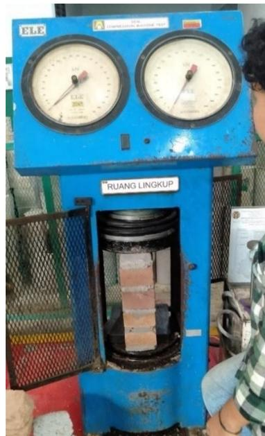
**Gambar 4.14** proses pengujian kuat tekan pasangan bata
