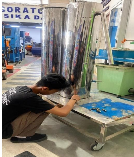
Gambar 4. 26 Penguncian baut tabung kondensor
