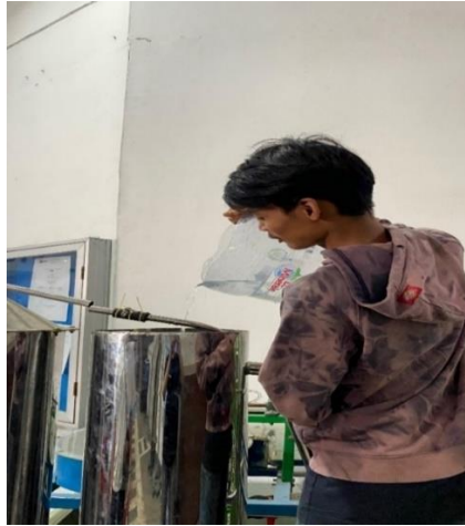
Gambar 4. 30 Meletakkan air pada ketel dan kondensor
