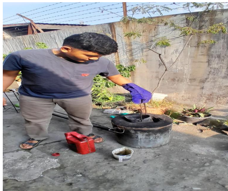
Gambar 4. 6 Menempatkan kowi ke tengah tungku peleburan
