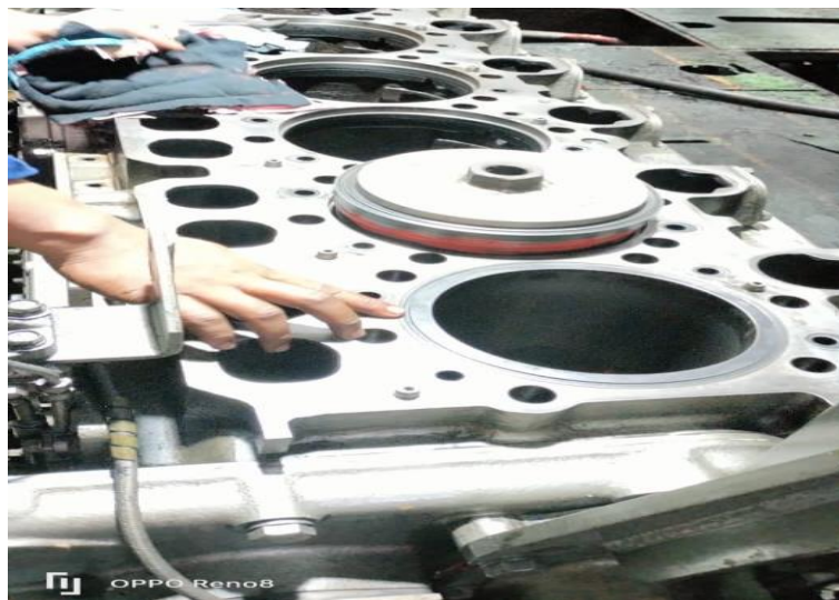
Gambar 4.4 Pemasangan Korter silinder Blok
