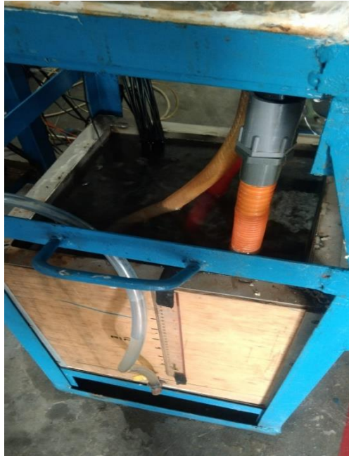
Mengisi air pada bak penampung sebanyak 36 L
