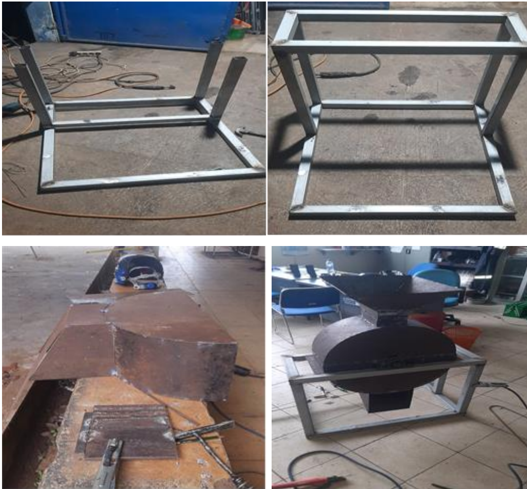
Gambar 4.2 4 Hasil pengelasan besi rangka dan besi plat
