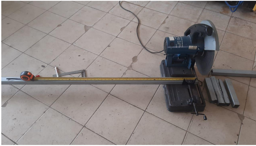
Gambar 4.2 1 Hasil Pemotongan Besi Hollow untuk rangka mesin
