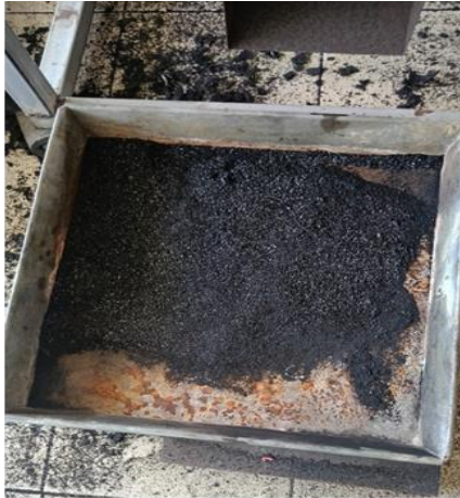
Gambar 4.3. 1 Hasil uji kinerja mesin penghancur arang tempurung
