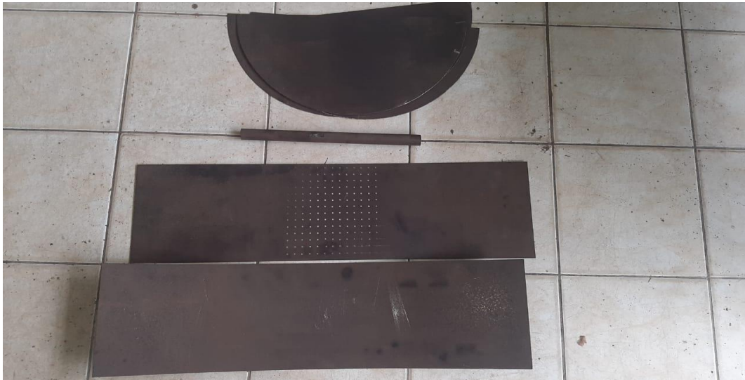
Gambar 4.2 2 Hasil Pemotongan Besi Plat untuk Cover Mesin
