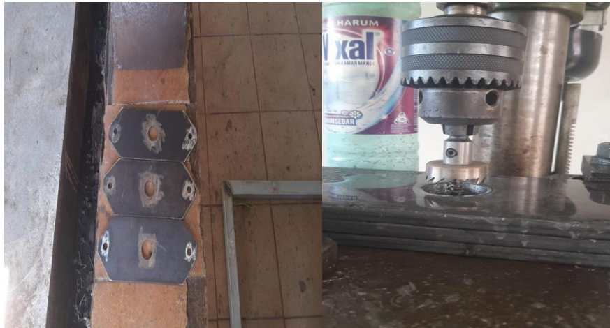
Gambar 4.2 3 Hasil pemotongan dan pengeboran plat dudukan hammer poros dan mata hammer penghancur arang
