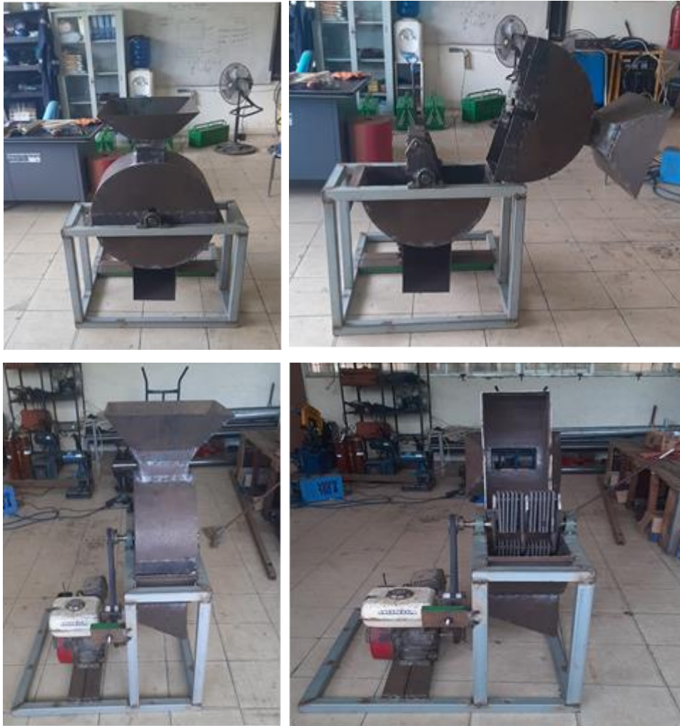
Gambar 4.2 5 Hasil perakitan komponen-komponen mesin penghancur arang tempurung
