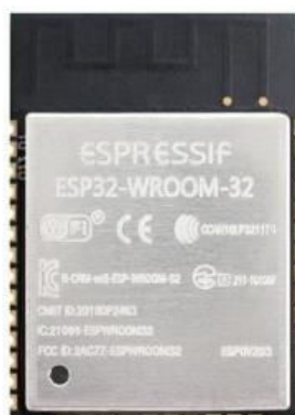
Gambar 2.13 bentuk fisik ESP 32
