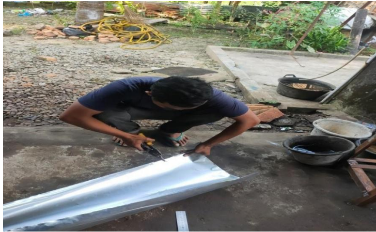
Gambar 4.7. Proses pemotongan alluminium
