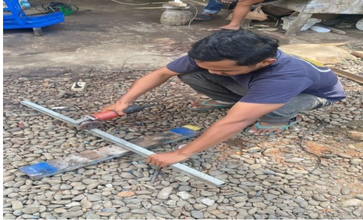
Gambar 4.6. Proses pemotongan besi hellow
