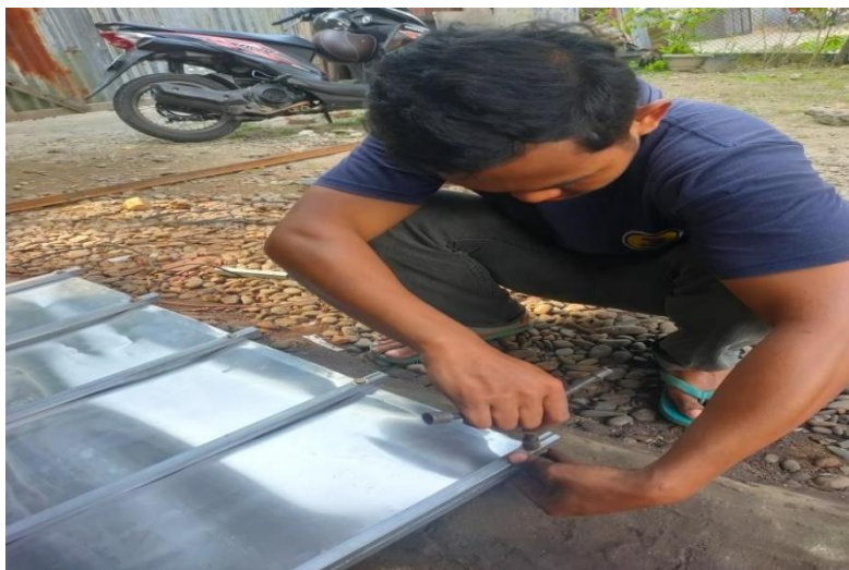
Gambar 4.8. Proses perakitan meja penampung bibit
