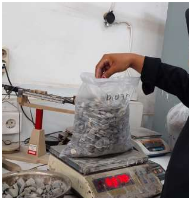
Gambar L.8: Penimbangan agregat sesuai takaran.
