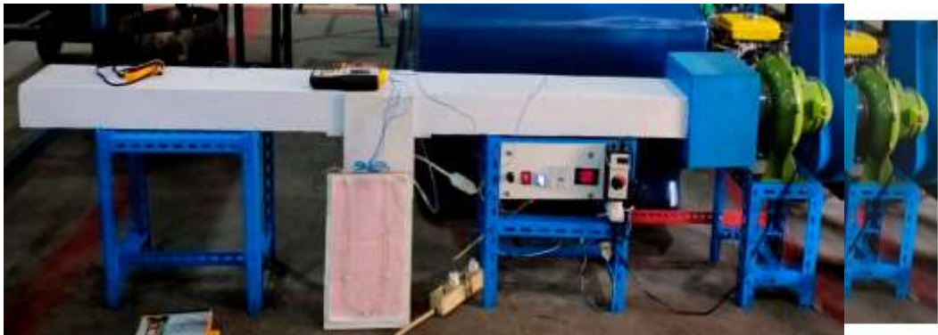
Gambar 3.5 Saluran udara segiempat
