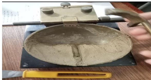
Gambar 4.5: Proses pengujian indeks plastisitas tanah.
