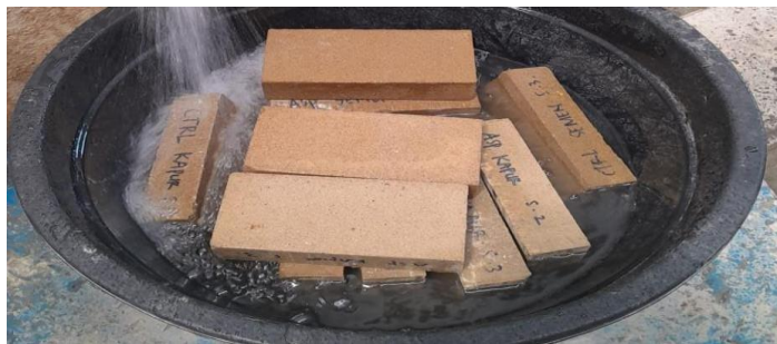
Gambar 4.6: Proses pengujian daya tahan bata.
