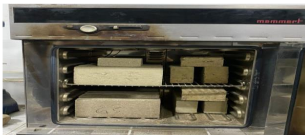
Gambar 4.10: Proses pengeringan benda uji menggunakan oven.
