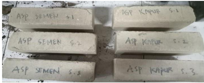
Gambar 4.7: Benda uji yang telah selesai tes uji daya tahan selama 12 hari.
