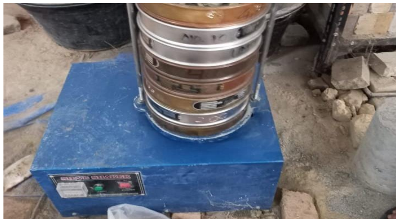
Gambar 4.3: Pengujian analisa saringan tanah galong.
