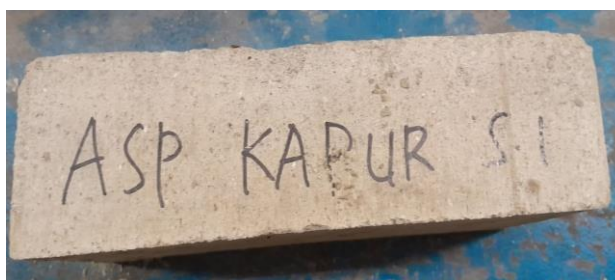
Gambar 4.11: Benda uji setelah selesai uji daya serap air.
