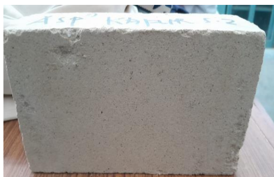
Gambar 4.17: Benda uji setelah pengujian kadar garam.
