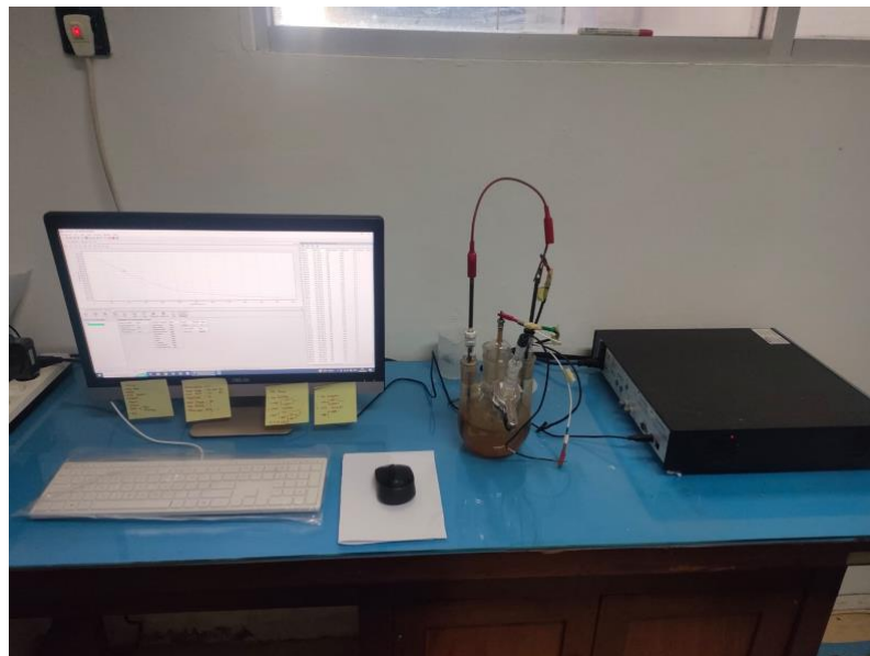
Gambar 3.14 Lintasan Kerja Uji Korosi
