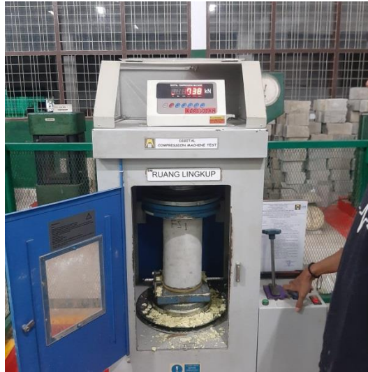
Gambar L. 9: Pengujian kuat tekan
