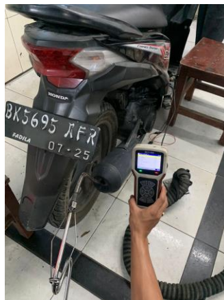
Gambar 3.24 Pengujian emisi gas buang dengan menggunakan Gas Analyzer
