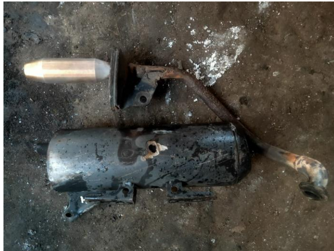
Gambar 3.25 Knalpot modifikasi menggunakan silinder berongga 40mm
