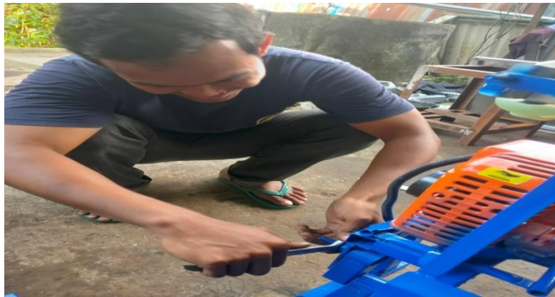
Gambar 4.17. Proses pemasangan dan penyetelan ayunan as
