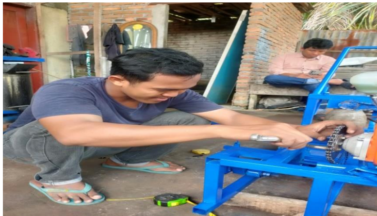
Gambar 4.15. Proses pemasangan sporket dan rantai
