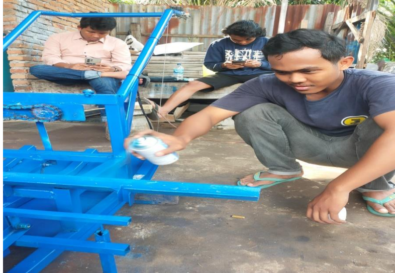
Gambar 4.14. Proses pengecatan pada rangka
