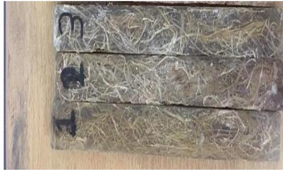
Gambar 3.33 Spesimen uji *Three Point Bending*
