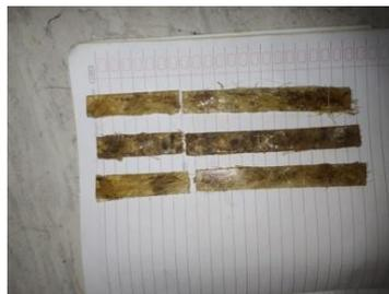
Gambar 4.2 Hasil pengujian bending 70% Resin : 30% Serat, 60% Serat Durian dan 40% Serat Pandan berduri.
