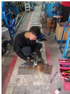
Gambar 3.30 Proses Penghalusan Permukaan Cetakan
