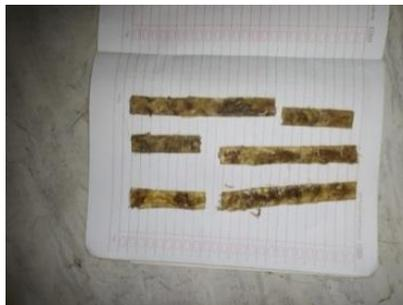
Gambar 4.4 Hasil Pengujian bending 70% Resin : 30% Serat, 80% Serat Durian dan 20% Serat Pandan berduri.
