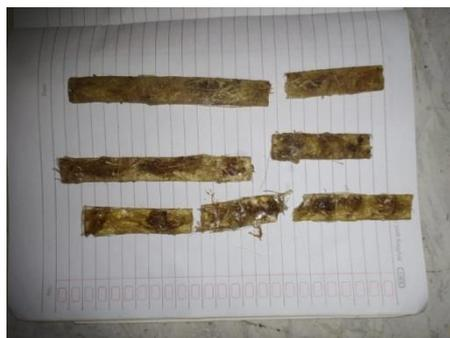
Gambar 4.5 Hasil Pengujian bending 70% Resin : 30% Serat, 90% Serat Durian dan 10% Serat pandan berduri.
