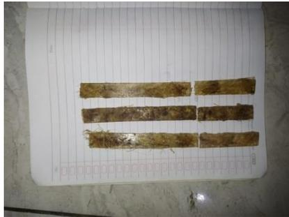
Gambar 4.3 Hasil Pengujian bending 70% Resin : 30% Serat, 70% Serat Durian dan 30% Serat Pandan berduri.
