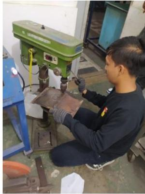
Gambar 3.31 Proses Pengeboran untuk membuat lubang baut
