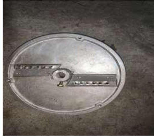
Gambar 4.7 Mata Pisau Mesin Pemotong Ubi Rambut
