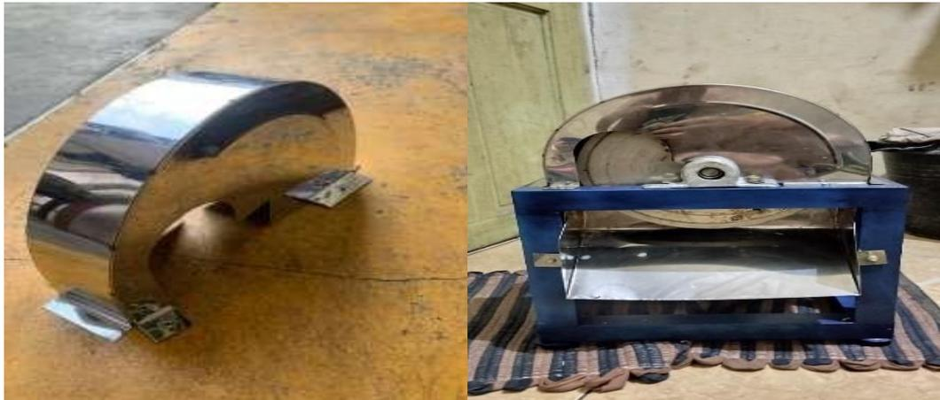
Gambar 4.11 Hasil Pemasangan Plat Besi dan Plat *Steinless*
