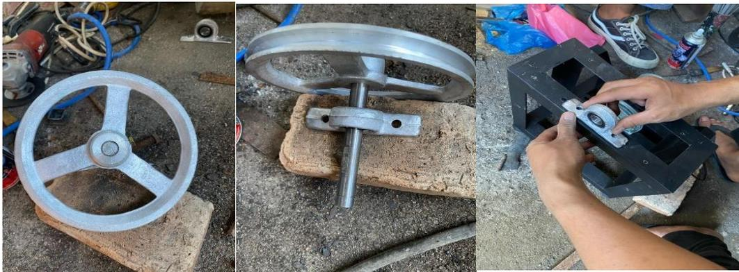
Gambar 4.9 Pemasangan *Pulley*
