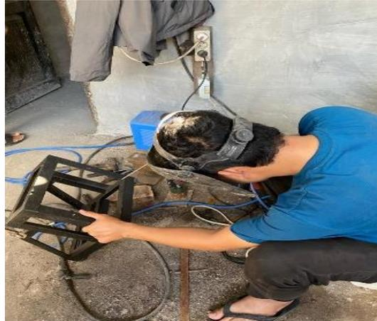
Gambar 4.5 Pengelasan Rangka Mesin
