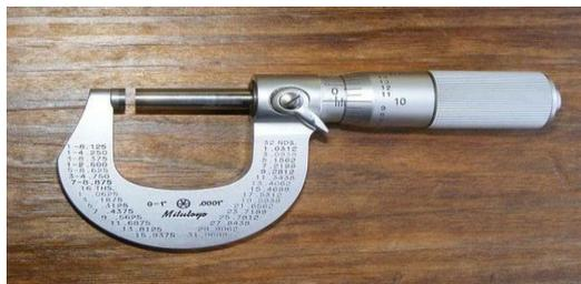
Gambar 3.15 mikrometer sekrup
