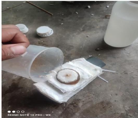
Gambar 4. 5 Proses pengecoran
