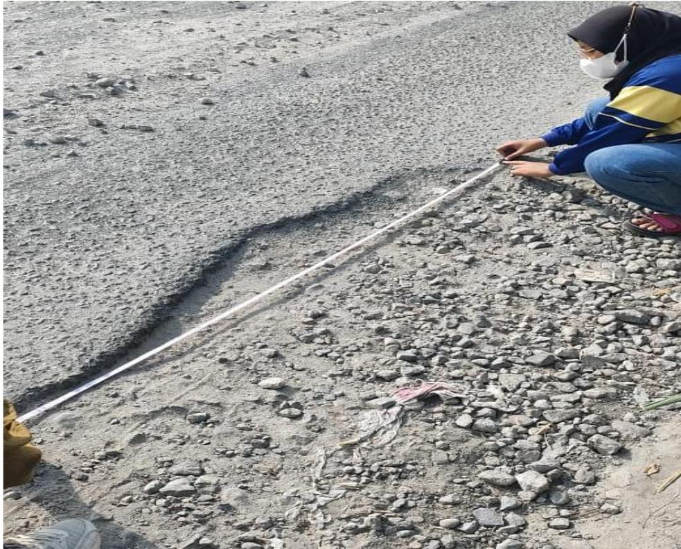
Gambar L.1 : Mengukur Data Kerusakan Jalan
