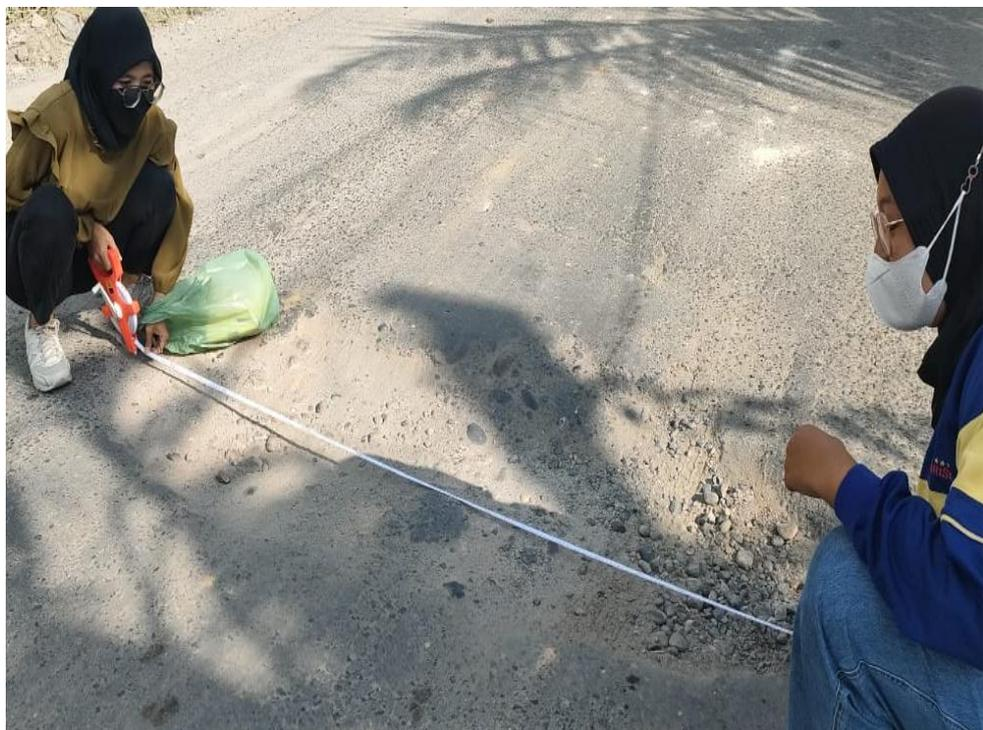
Gambar L.2 : Mengukur Data Kerusakan Jalan
