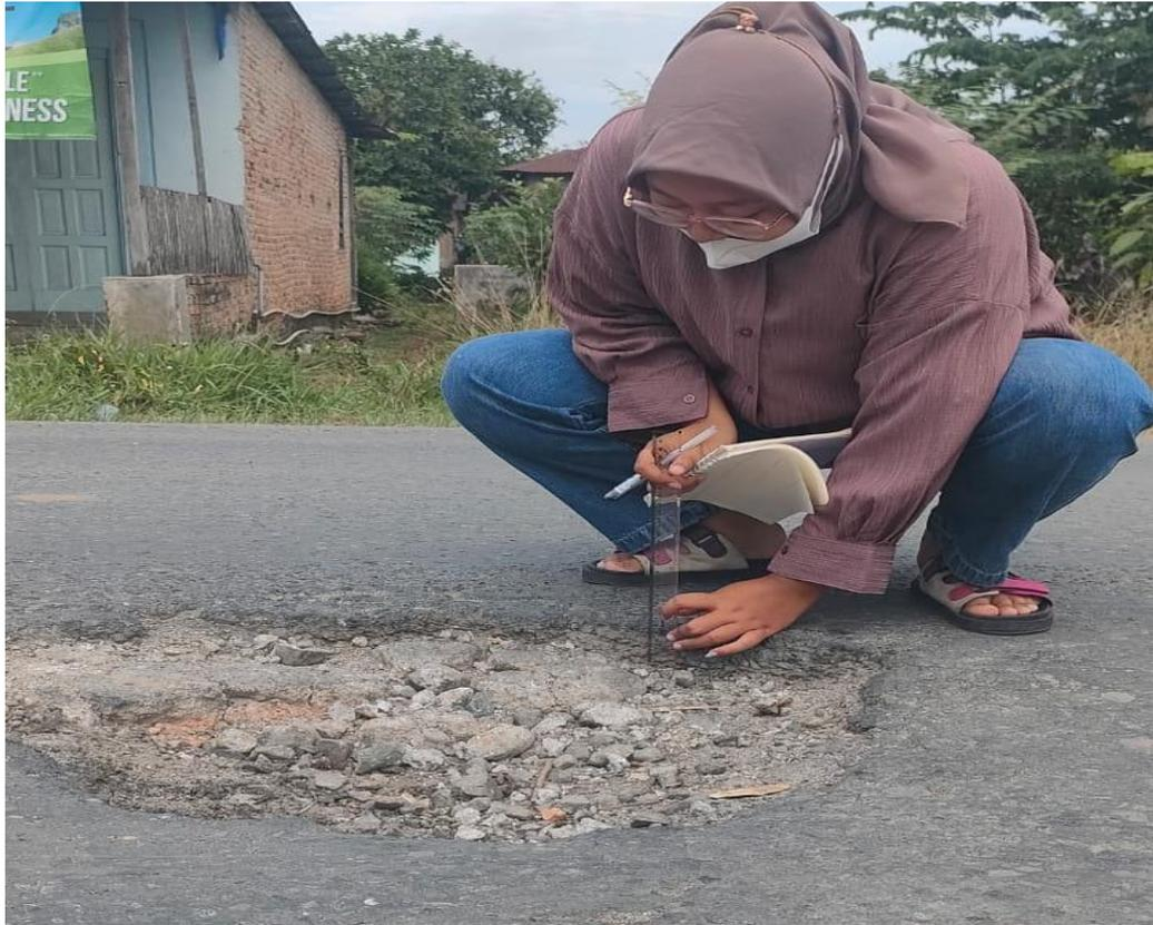
Gambar L.3 : Mengukur Data Kerusakan Jalan
