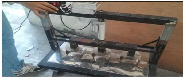
Gambar 5.1 hidrolik dan pengepres dalam keadaan naik
