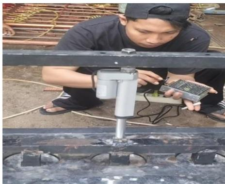
Gambar 4.8 Pengukuran Linear Actuator Hidrolik
