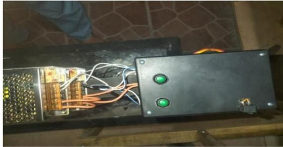
Gambar 5.4 sumber PLN yang terhubung adaptor
