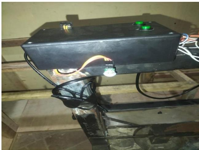
Gambar 5.2 tombol ON/OFF secara manual
