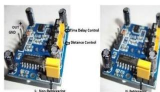
Gambar 2.14 Posisi Setiap PIN Pada Sensor PIR
