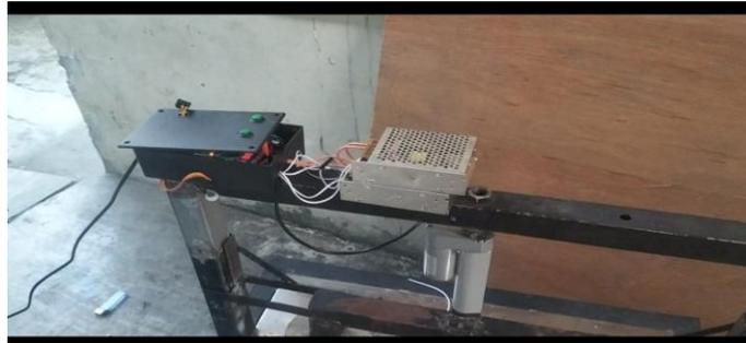
Gambar 5.5 Adaptor dan Relay yang terhubung
