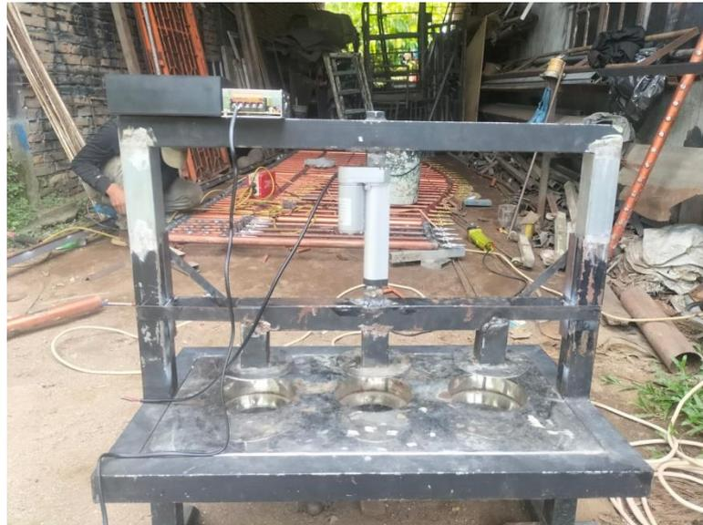
Gambar 4.9 pengukuran kecepatan hidrolik actuator
