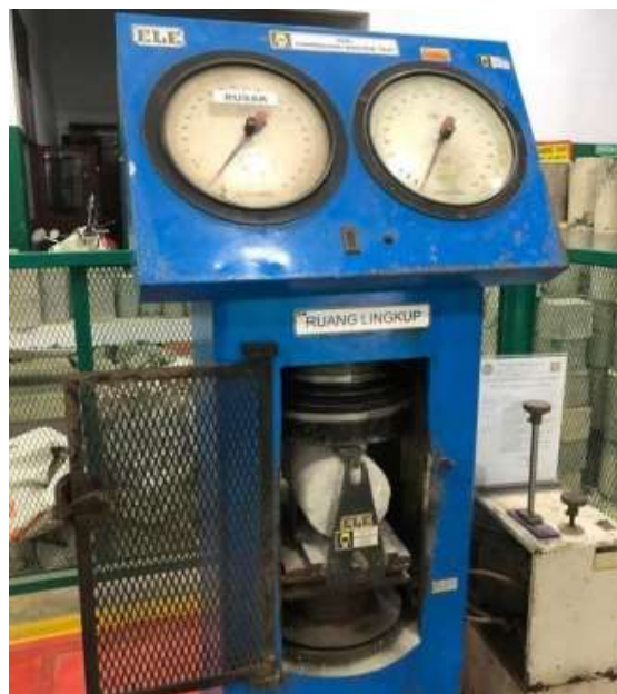
Gambar 3. 4 Proses pengujian kuat tarik belah.
