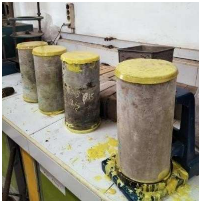
Gambar L. 14: Pemasangan capping pada benda uji
