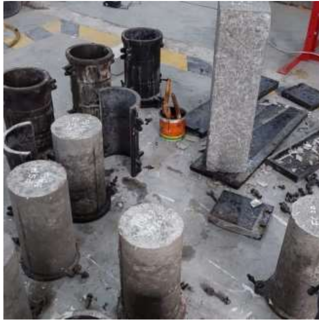
Gambar L. 13: Pemasangan capping pada benda uji
