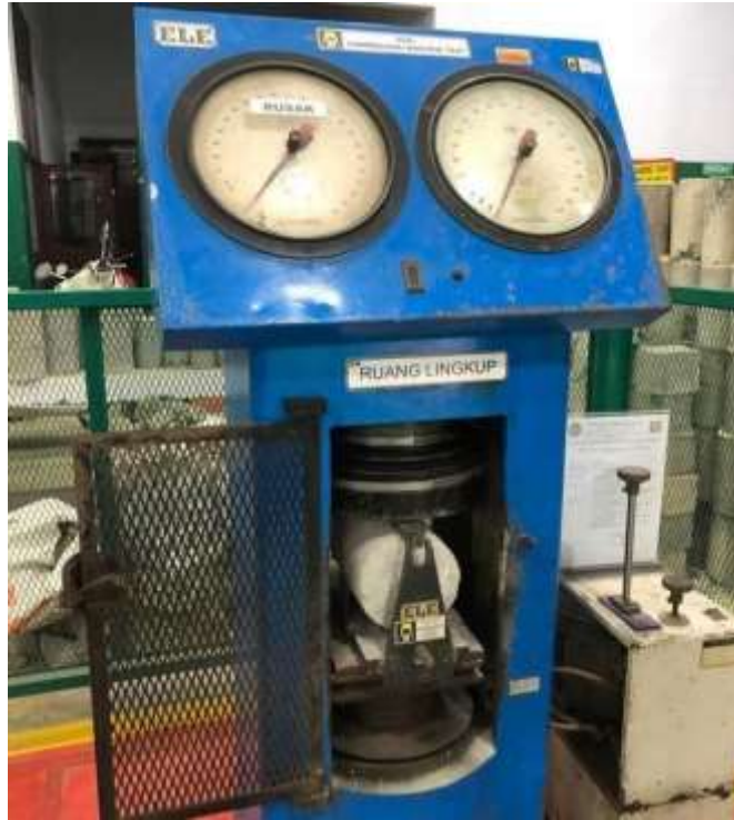
Gambar L. 15: Pengujian kuat tarik belah
