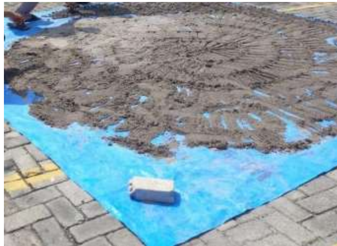
Gambar L.7: Penjemuran agregat halus
