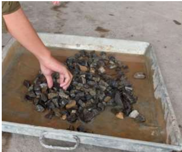
Gambar L.6: Penyucian agregat kasar
