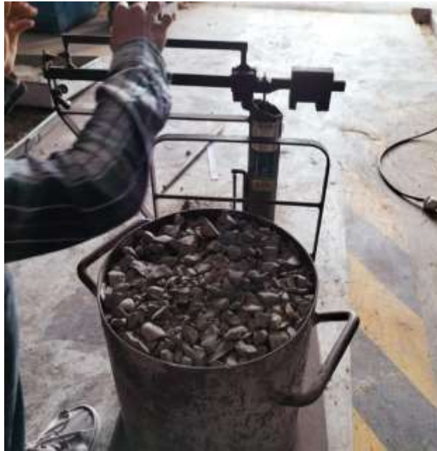
Gambar L.3: pengujian berat isi agregat
