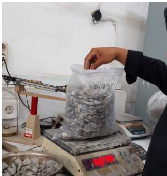
Gambar L.8: Penimbangan agregat sesuai takaran
