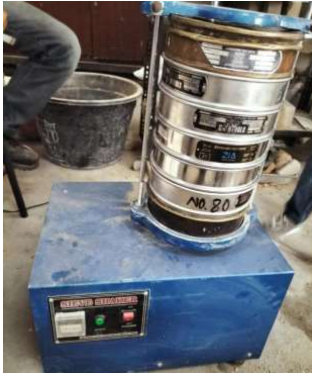
Gambar L.5: Pengujian analisa saringan
