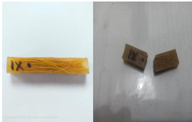
Gambar 4.9 Sebelum Dan Sesudah Pengujian Impak Perlakuan Kimia Selama 9 jam komposisi 10% serat
