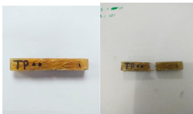
Gambar 4.10 Sebelum Dan Sesudah Pengujian Impak Tanpa Perlakuan Kimia komposisi 20% serat
