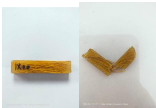
Gambar 4.15 Sebelum Dan Sesudah Pengujian Impak Perlakuan Kimia Selama 9 jam komposisi 20% serat
