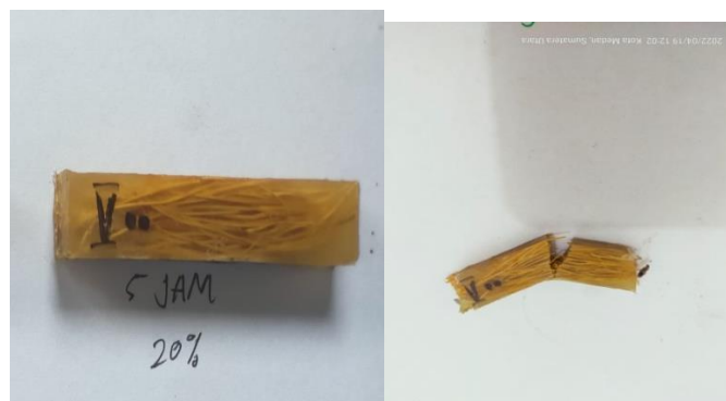
Gambar 4.13 Sebelum Dan Sesudah Pengujian Impak Perlakuan Kimia Selama 5 jam komposisi 20% serat
