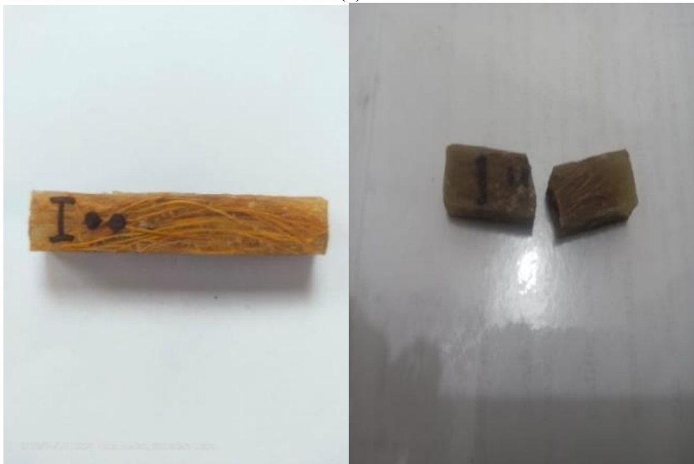
Gambar L 3 (a).Spesimen dengan serat 10% perendaman 1 jam .(b).Spesimen dengan serat 20% perendaman 1 jam.
