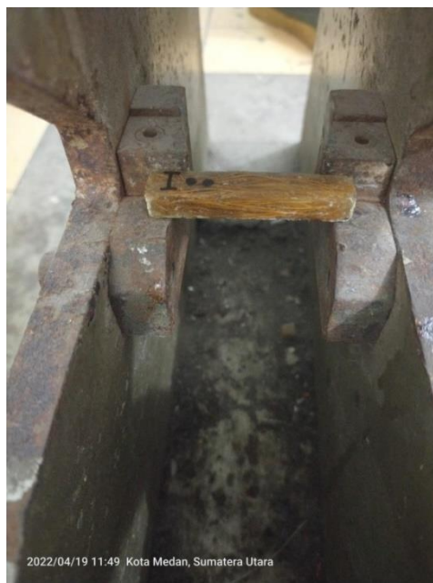
Gambar 3.29. Peletakan spesimen di atas penopang
