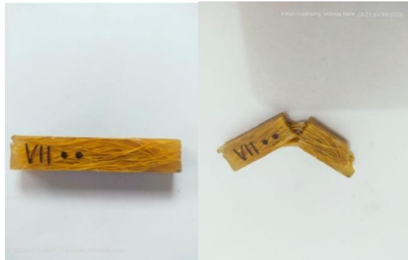
Gambar 4.14 Sebelum Dan Sesudah Pengujian Impak Perlakuan Kimia Selama 7 jam komposisi 20% serat
