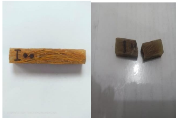
Gambar 4.11 Sebelum Dan Sesudah Pengujian Impak Perlakuan Kimia Selama 1 jam komposisi 20% serat
