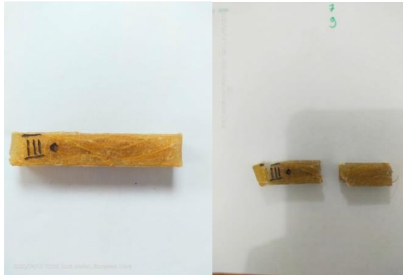
Gambar 4.6 Sebelum Dan Sesudah Pengujian Impak Perlakuan Kimia Selama 3 jam komposisi 10% serat
