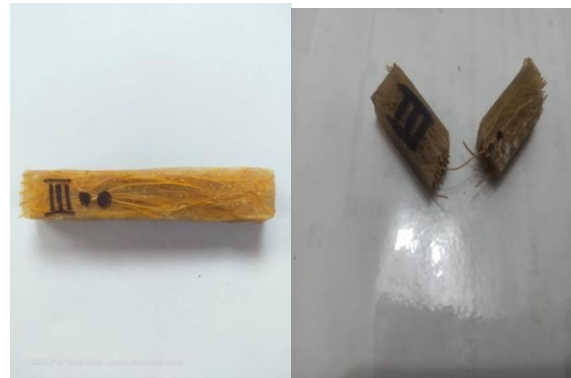
Gambar 4.12 Sebelum Dan Sesudah Pengujian Impak Perlakuan Kimia Selama 3 jam komposisi 20% serat
