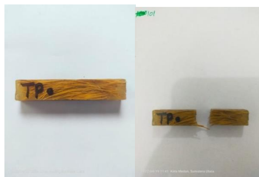
Gambar 4.4 Sebelum Dan Sesudah Pengujian Impak TanpaPerlakuan Kimia Selama 1 jam komposisi 10% serat
