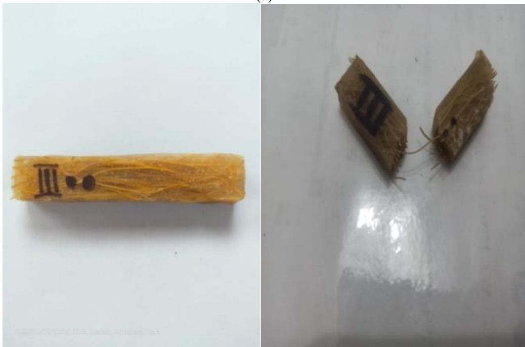
Gambar L 4 (a).Spesimen dengan serat 10% perendaman 3 jam .(b).Spesimen dengan serat 20% perendaman 3 jam.
