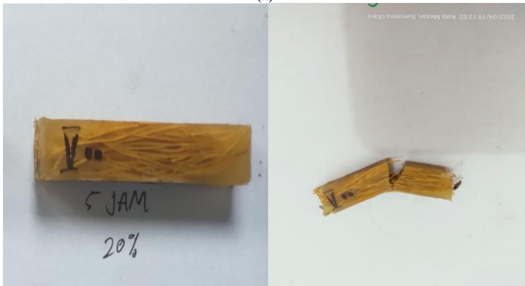
Gambar L 5 (a).Spesimen dengan serat 10% perendaman 5 jam. (b).Spesimen dengan serat 20% perendaman 5 jam.
