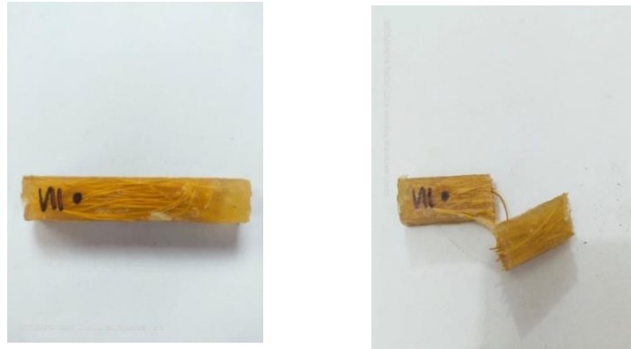
Gambar 4.8 Sebelum Dan Sesudah Pengujian Impak Perlakuan Kimia Selama 7 jam komposisi 10% serat
