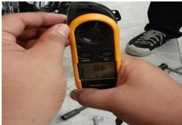
Gambar 3.29 Pengukuran kecepatan angin gas buang
