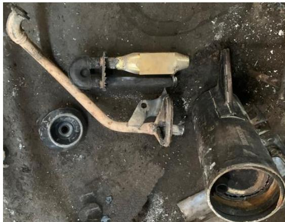
Gambar 3.31. Knalpot modifikasi menggunakan pipa berongga 48mm
