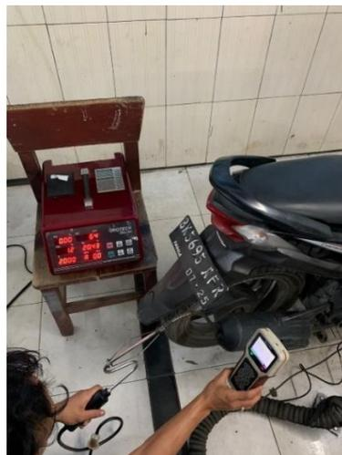
Gambar 3.25 Pengujian emisi gas buang dengan menggunakan *Gas Analyzer*
