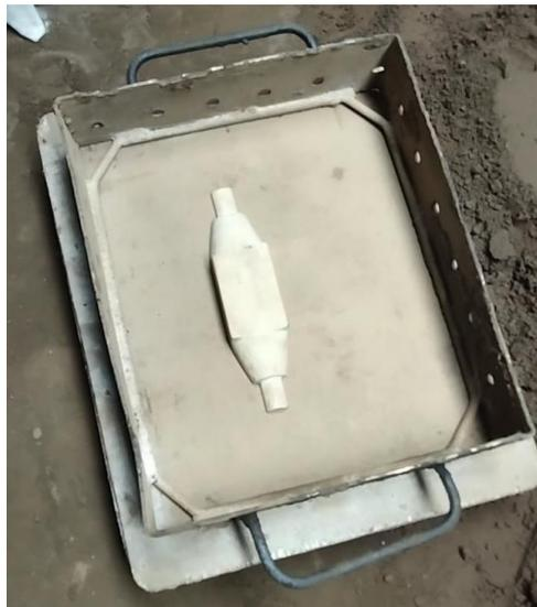
Gambar 3.14. Pembuatan Cetakan
