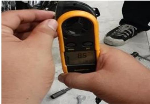
Gambar 3.24 Pengukuran kecepatan angin gas buang
