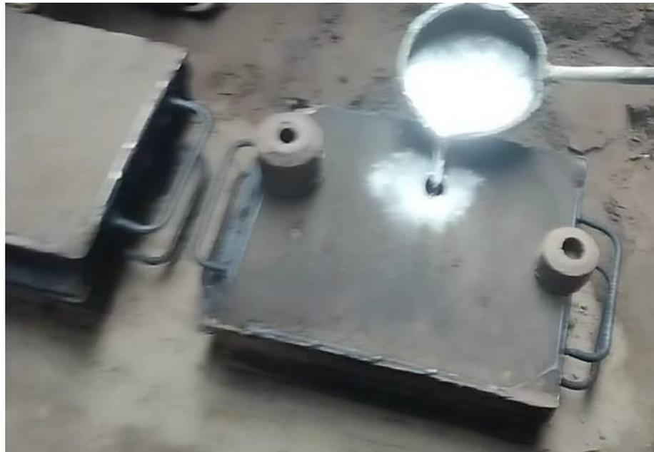
Gambar 3.16. Penuangan logam cair kedalam cetakan
