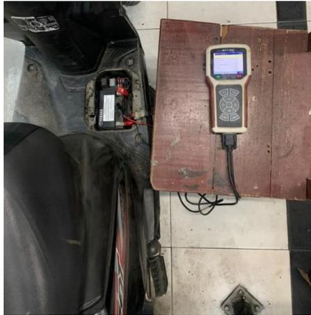
Gambar 3.23 Pengukuran rpm dengan *Fi Scanner*
