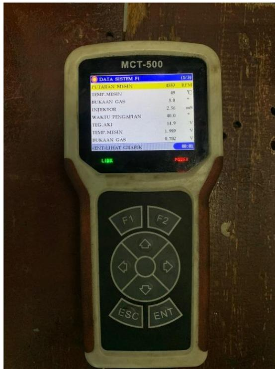
Gambar 3.28 Pengukuran rpm dengan *Fi scanner*
