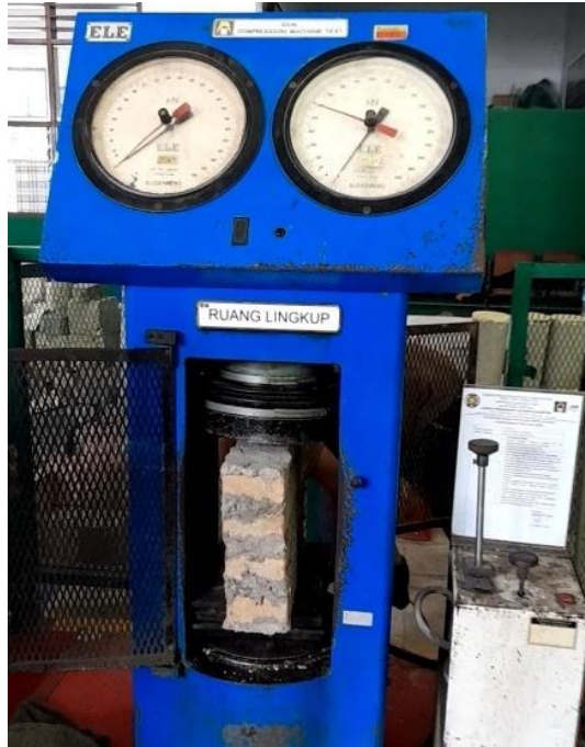
Gambar L.11 : Uji kuat tekan pasangan bata
