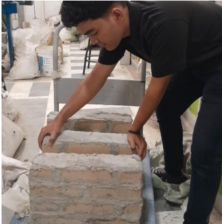
Gambar L.9: Pasangan bata yang telah berumur 28 hari
