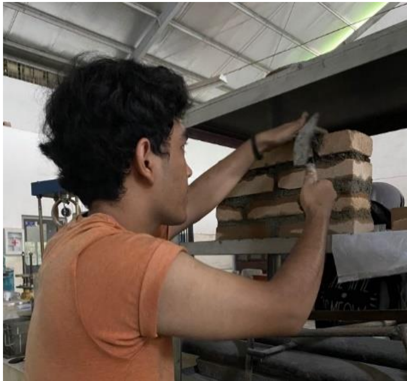
Gambar L.7: Pembuatan pasangan bata
