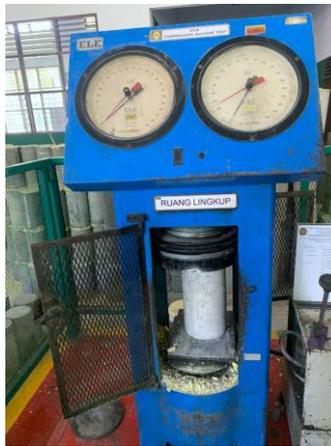
Gambar L.19: Pengujian Kuat Tekan Beton Variasi BAATG 3%, 5%, dan 7%
