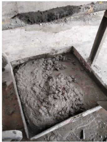
Gambar L.10: Campuran Beton Setelah Proses *Mixer*
