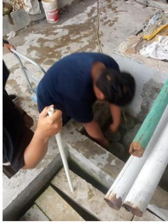
Gambar L.15: Pengangkatan Benda Uji Setelah Perendaman 28 Hari
