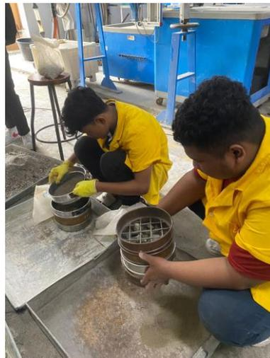
Gambar L.2: Pengujian Agregat Halus & Agregat Kasar
