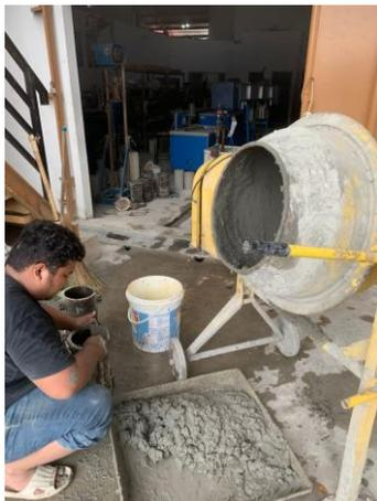
Gambar L.11: Proses Pembuatan Benda Uji
