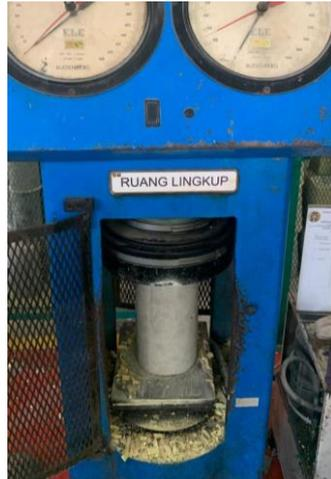
Gambar L.18: Pengujian Kuat Tekan Beton Variasi BAAT 3%, 5%, dan 7%
