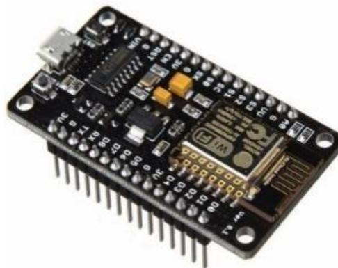
Gambar 2.1. Nodemcu ESP8266 [16]
