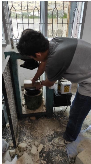
Gambar 4.8: Proses pengujian kuat tekan bata.
