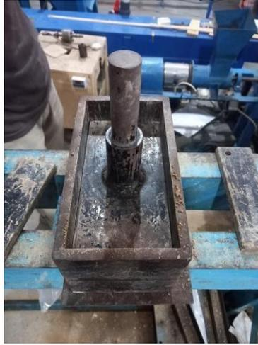
Gambar L.7 : Proses pencetakan bata.
