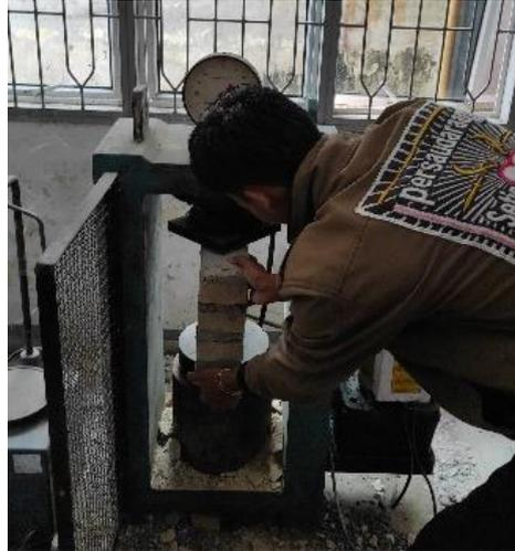
Gambar 4.8: Proses sebelum pengujian kuat tekan pasang batu bata.
