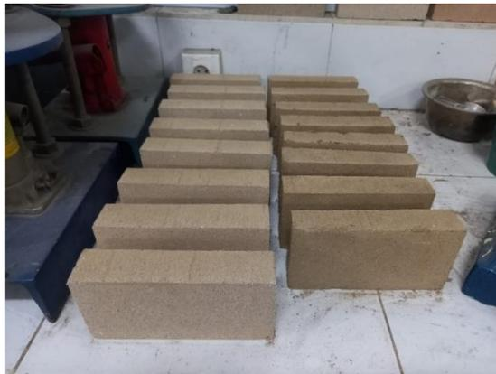
Gambar 4.17: Benda uji sifat tampak bata untuk tanah galong.
