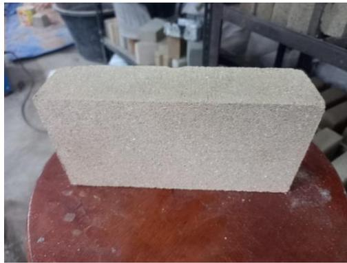
Gambar L.8 : Batu bata tanah galong dengan campuran serbuk kulit telur.
