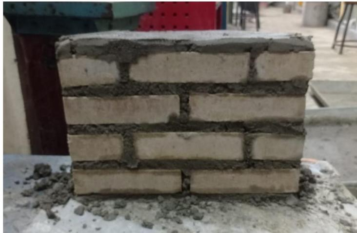
Gambar 4.7: Model benda uji untuk pengujian kuat tekan pasang bata.
