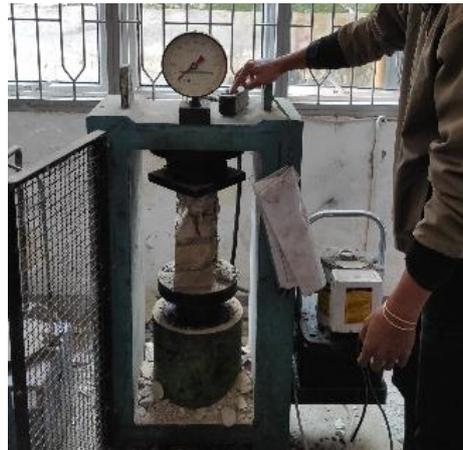
Gambar 4.9: Proses setelah pengujian kuat tekan pasang batu bata.
