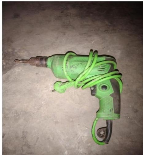
Gambar 3.6 Mesin Bor Tangan
