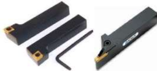
Gambar 2.9 Pahat bubut sisipan pengikatan diklem/ dibaut terpasang pada pemegangnya untuk pembubutan bagian luar
