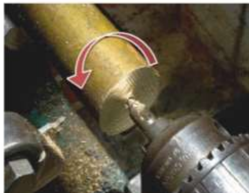
Gambar 2.25 Putaran mesin bubut harus berlawanan dengan mata sayat bor senter
