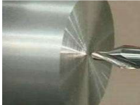
Gambar 2.24 Permukaan benda kerja harus benar-benar rata sebelum pembuatan lubang senter
