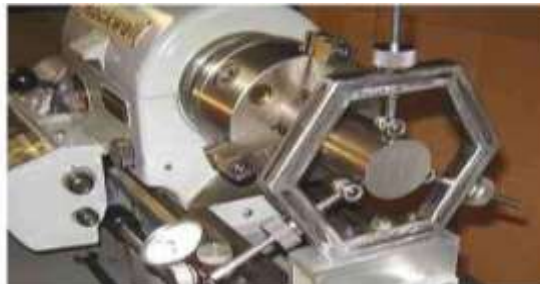
Gambar 2.15 Pemasangannya benda kerja berukuran panjang sebelum dibubut permukaannya
