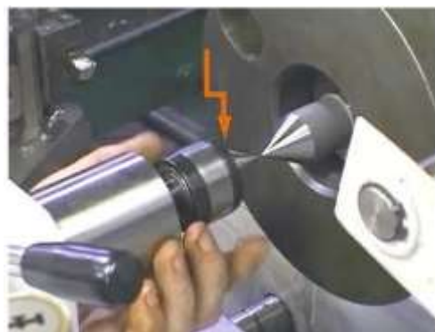
Gambar 2.21 Mengatur kesepusatn sumbu dengan alat Bantu batang pengetes dan dial indikator
