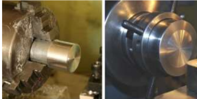
Gambar 2.14 Pemasangannya benda kerja berukuran pendek sebelum dibubut permukaannya
