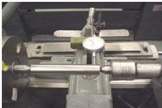
Gambar 2.21 Mengatur kesepusatn sumbu dengan alat Bantu batang pengetes dan dial indikator
