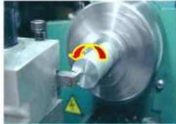
Gambar 2.16 Pembubutan muka start pahat bubut diawali dari sumbu senter benda kerja
