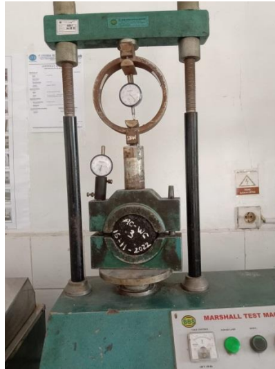
Gambar 2.2. Alat Pengujian Marshall (Laboratorium PT. Adhi Karya)
