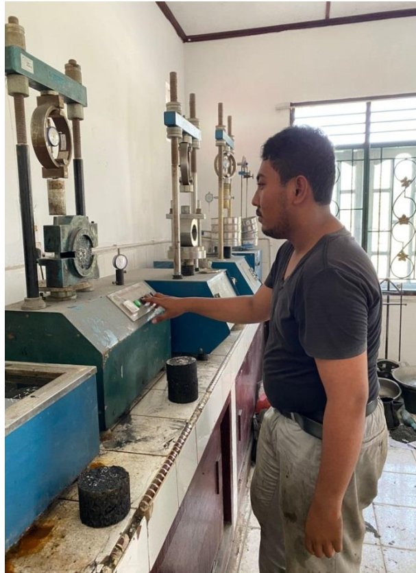
Gambar L12 : Pengujian Marshall Dengan Alat Marshall Compression.
