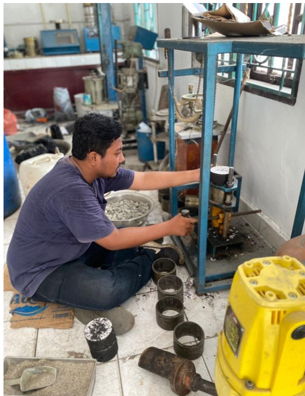
Gambar L12 : Proses pengeluaran Benda uji Dari Cetakan
