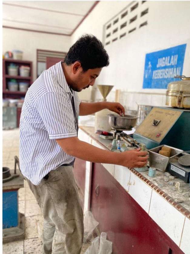
Gambar L.7: Proses Penyaringan Agregat
