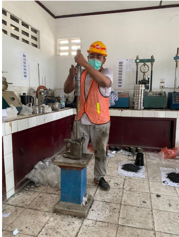
Gambar L11: Penumbukan Benda uji.
