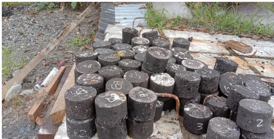
Gambar L 13: Benda uji Setelah dilakukan pengujian dengan Alat Marshall Compression.
