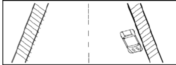
Gambar 2.11: Pola parkir paralel daerah turunan (Direktur Jendral Perhubungan Darat (Dapartemen Perhubungan), 1996).
