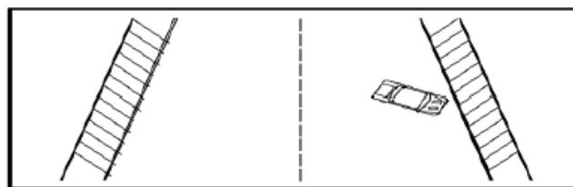
Gambar 2.17: Pola parkir menyudut pada daerah turunan (Direktur Jendral Perhubungan Darat (Dapartemen Perhubungan),1996).
