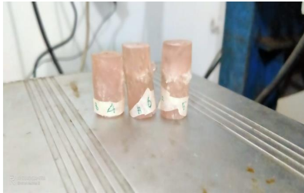
Gambar 4.3 Hasil Pengujian Tekan 80%Resin 10%fiberglass 10% Ampas Tebu dengan standard ASTM D695 dalam pengujian tekan
