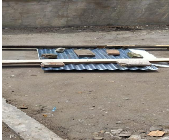
Gambar 3.19 proses penekanan komposit serat tebu dan glass
