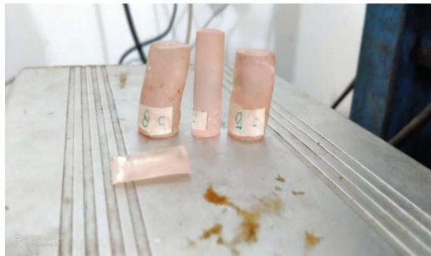
Gambar 4.4 Hasil Pengujian Tekan 90%Resin 5%fiberglass 5% Ampas Tebu dengan standard ASTM D695 dalam pengujian tekan
