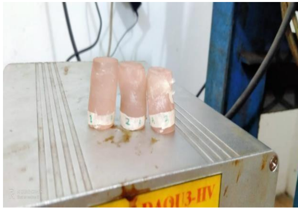
Gambar 4.2 Hasil Pengujian Tekan 70%Resin 20%fiberglass 10% Ampas Tebu dengan standard ASTM D695 dalam pengujian tekan
