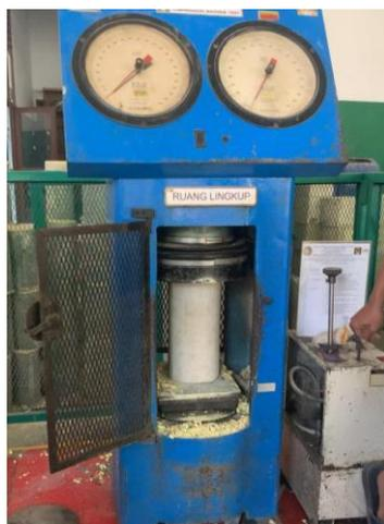
Gambar L-10: Pengujian Kuat Tekan Beton
