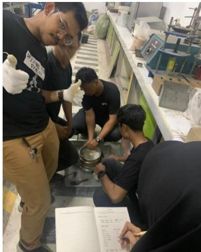
Gambar L-2: Pengujian Agregat halus dan Agregat kasar
