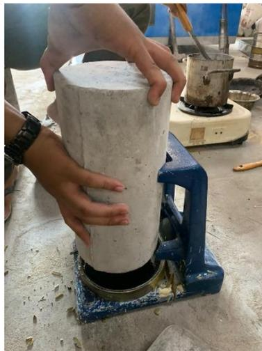
Gambar L-8: Pembuatan *Capping* untuk pengujian kuat tekan
