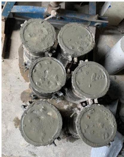
Gambar L-6: Pencetakan Setiap Variasi Beton
