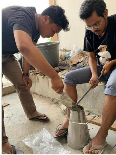
Gambar L-4: Pengujian *Slump*
