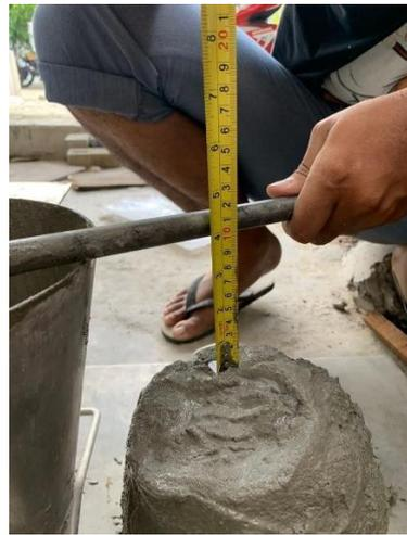
Gambar L-5: Perhitungan Nilai *Slump*
