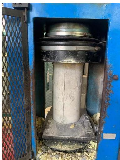
Gambar L-11: Kehancuran Benda Uji Setelah Pengujian
